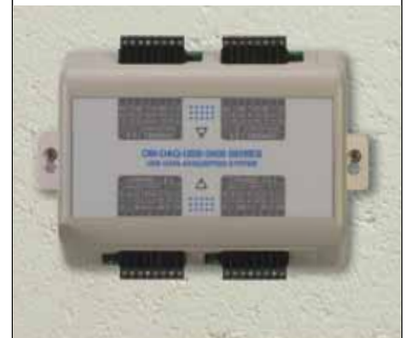
El OM-DAQ-USB-2401 incluye hardware para montaje tanto en riel DIN como en pared; ambos se muestran aquí.
