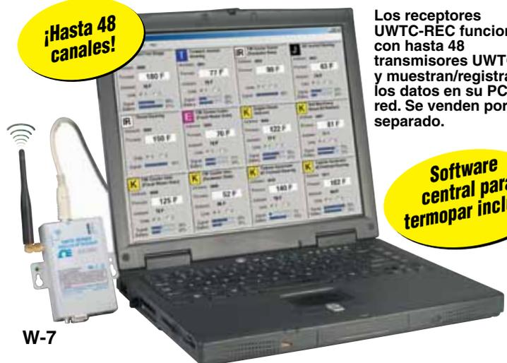
Los receptores UWTC-REC funcionan con hasta 48 transmisores UWTC y muestran/registran los datos en su PC o red. Se venden por separado.
