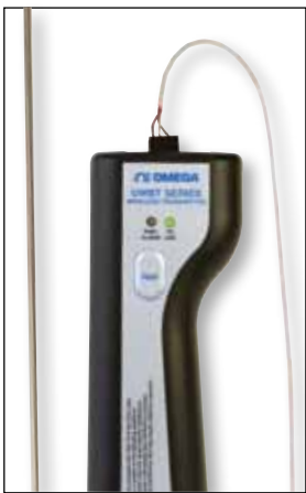
Figura 3c: cable RTD conectado al UWBT-RTD-TB
