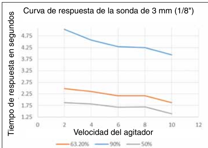
Figura 5a: respuesta de temperatura de la sonda de 3 mm (1/8")
