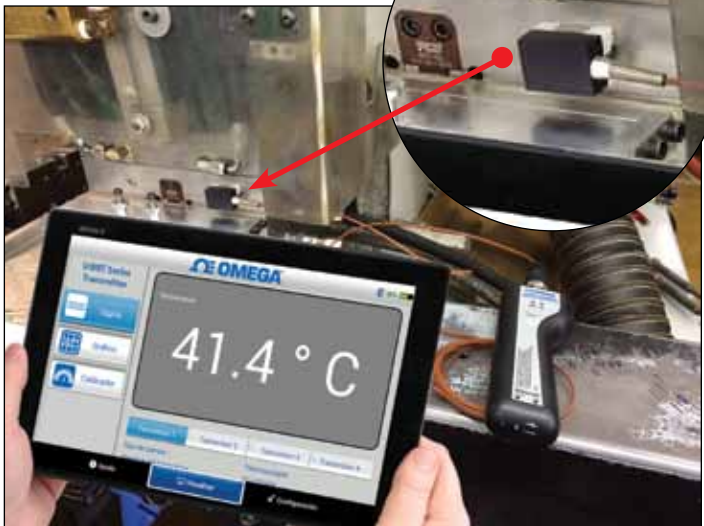
Figura 1: transmisor UWBT-TC-UST supervisando la temperatura de moldeado
