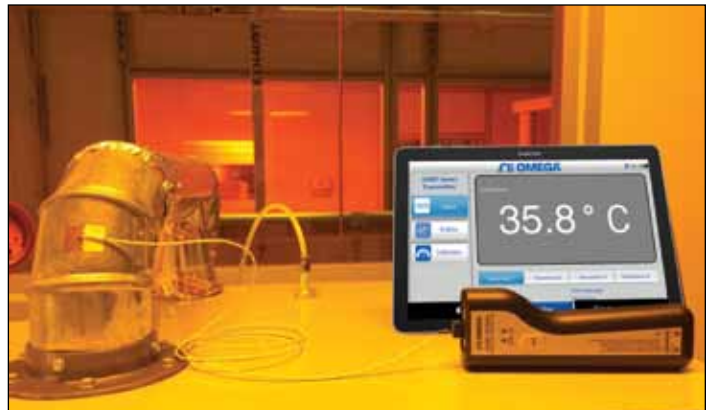
Figura 3: UWBT-RTD-TB supervisando la temperatura de los gases de escape
