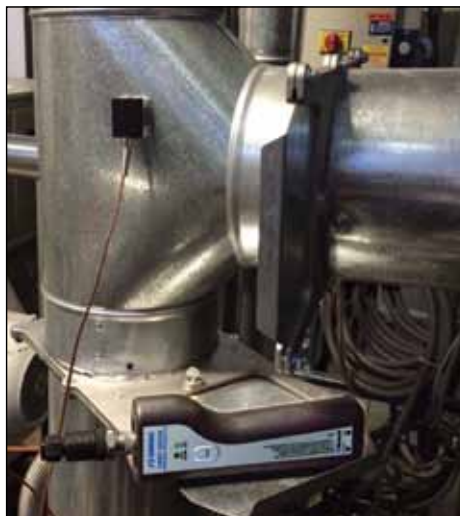
Figura 5: sonda magnética 88401K montada en un sistema de escape de vacío
