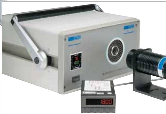
Se muestra calibrando el pirómetro OS1552-A. Visite [es.omega.com](http://es.omega.com) para obtener más información.
