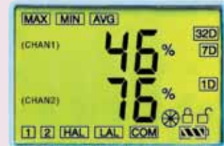
CTXL-DPR: pantalla local de proceso doble
