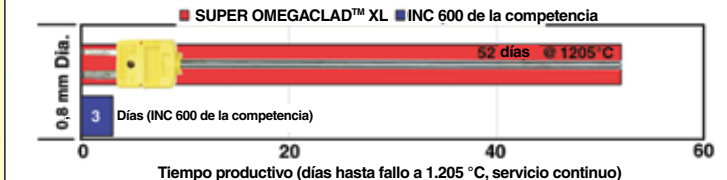
Vida útil de sondas de tipo K con vaina Super OMEGACLAD™ XL vs. sondas de tipo K con vaina de Inconel™ 600 mantenidas a 1.205 °C
