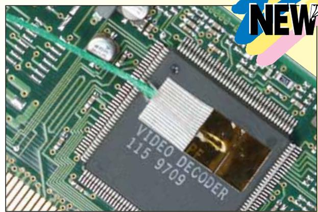
El terminal de montaje autoadhesivo es ideal para la colocación “dirigida” del elemento sensor. En cuanto se haya colocado el elemento, puede utilizarse “tal cual”, para aplicaciones tales como la supervisión de la temperatura de componentes electrónicos durante la fabricación de placas. También puede cementarse en el lugar con OMEGABOND™ para temperaturas superiores.
