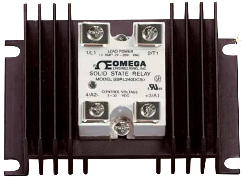
El relé de estado sólido SSRL240DC50 se muestra en un tamaño inferior al real con un disipador térmico FHS-2. Consulte P-114 para más información.
